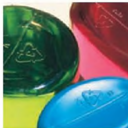
▲ Figura 12.23 Símbolos de reciclaje. La mayoría de los recipientes de plástico fabricados en la actualidad tienen un símbolo de reciclaje impreso en ellos, el cual indica el tipo de polímero utilizado para elaborar el recipiente y la facilidad con que se recicla dicho polímero.
